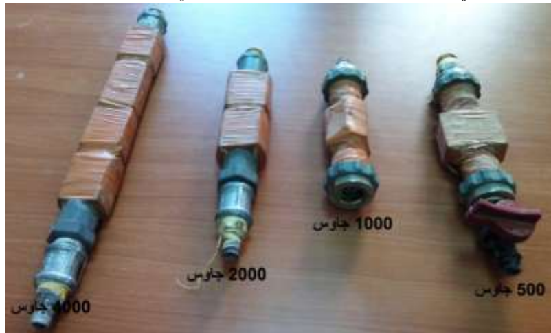
الشكل (3) منظومات المغنطة التي تم استعمالها في التجارب
